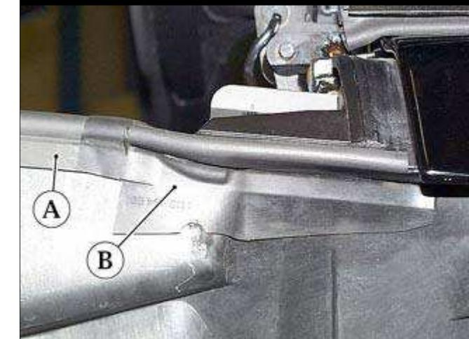
软顶机架和盖之间的密封通过周围密封圈（**A**）和末端的两个外部密封圈（**B**）提供。
